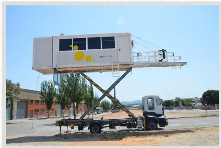
El transelevador **EuroAmbulift** de **Euromobility** permite operar en un amplio rango de aeronaves dado que su altura de operación (altura existente entre el asfalto y el piso de la pasarela delantera) es de 1.250 a 5.900 mm.
