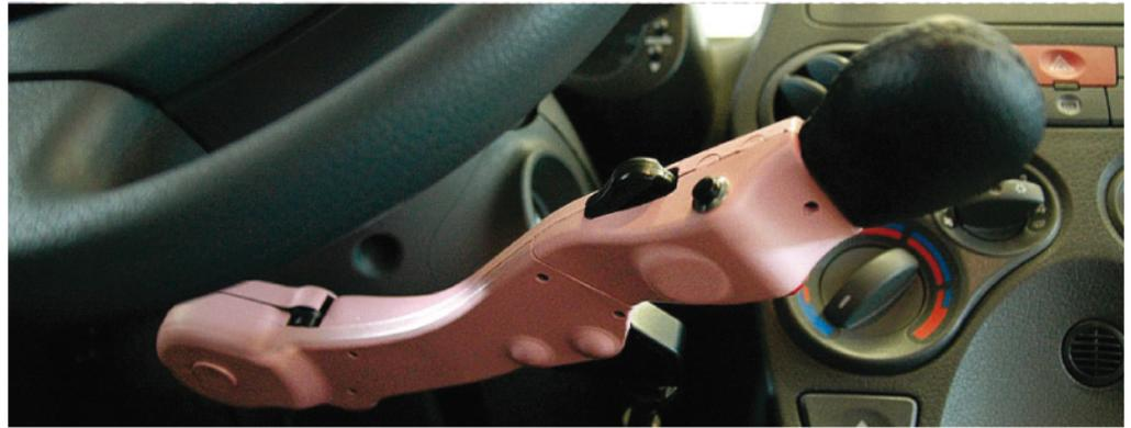
Dentro de una misma leva, el sistema de aceleración y el frenado son independientes
